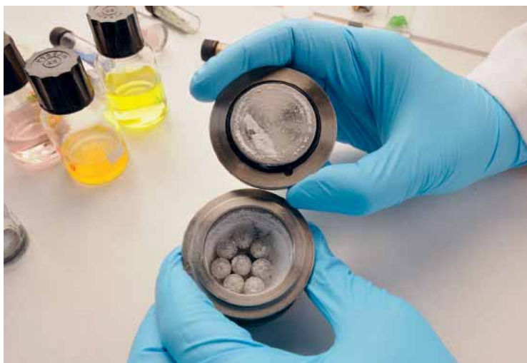
fig. Cette poudre de borane, matériau utilisé pour le stockage de l'hydrogène, a été obtenue par mécanosynthèse. Dans le broyeur, on distingue les billes en acier servant au procédé.
